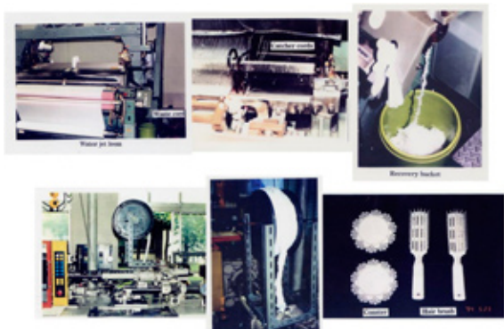
図1 合成繊維廃材を用いた射出成形
